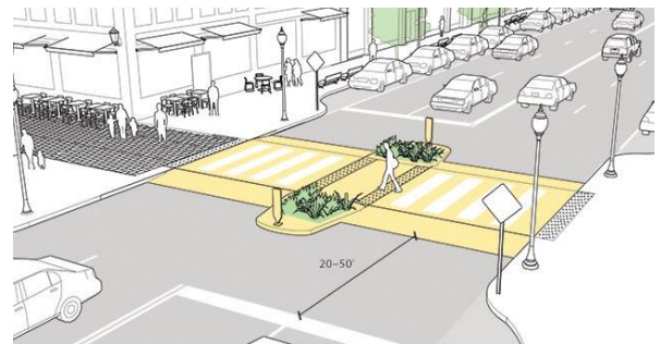
Attēls Nr. 8 Paceltās gājēju pārejas shematisks piemērs ar drošības salīņu 9
