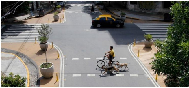
Attēls Nr.5. Vizuāli sašaurināts krustojums ar ielas krāsojumu, stabiņiem un gājēju pārejām 6
