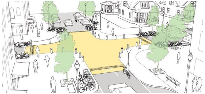
Attēls Nr.6 Shematisks attēlojums paceltā krustojuma piemēram. Krustojuma pacēlums veidots ietves augstumā. 7
