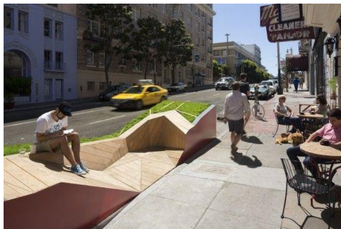
Attēls Nr. 30 Ielu mēbeles izvietotas uz ielas braucamās daļas, tādējādi radot ielas sašaurinājumu, kam ir satiksmi mierinošs efekts 31
