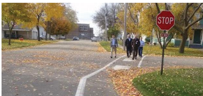
Attēls Nr. 20 Ar horizontālo marķējumu iezīmēta zona gājējiem uz ielas, kur nav izbūvētas ietves 21
