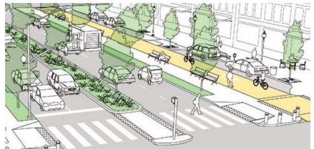
Attēls Nr. 13 Shematiskais attēls - gājēju pāreja ar ielas sašaurinājumiem un drošības salīņu 14
