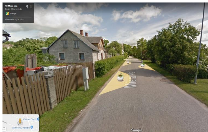
2.9.att. Miera ielas (30 km/h atļautais ātrums) esošā situācija (pa kreisi) un potenciālais risinājums ar ielas sašaurinājumiem un ielu mēbelēm (pa labi)
