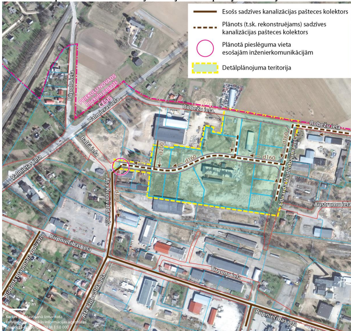
Attēls 13 Principiālais sadzīves kanalizācijas risinājums Detālplānojuma teritorijai
