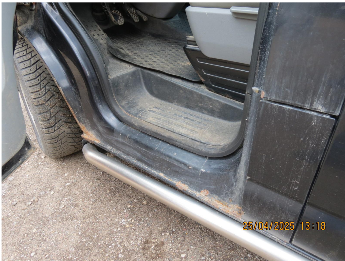
Korozija uz kreisās puses pakaļējā sāna panela.
