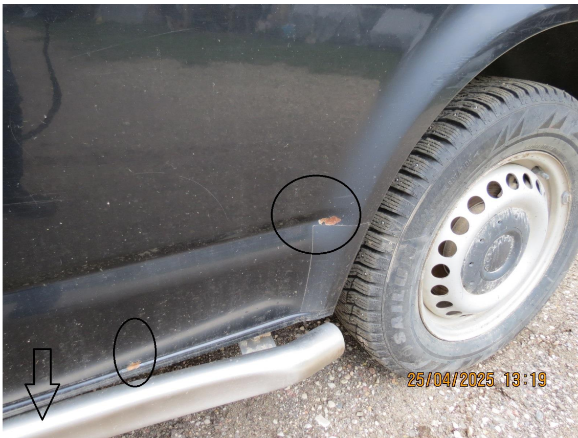
Korozija uz kreisās puses pakaļējā sāna panela.
